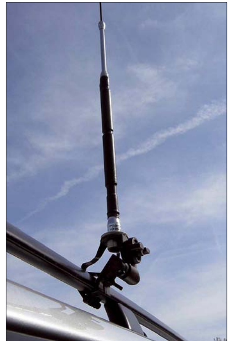
Antennenbefestigung an der Dachreling; links ist das Masseband zu erkennen.
