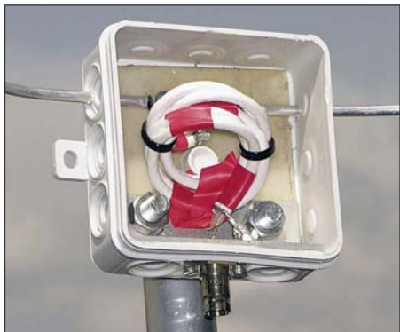
Bild 5: Blick in die Anschlussdose mit der Speisedrossel aus zweimal 75-Ω-Kabel parallel. Fotos (2) und Screenshots: DK7ZB
