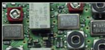
1. ZF: Drei Roofing-Filter bei 69,45 MHz
