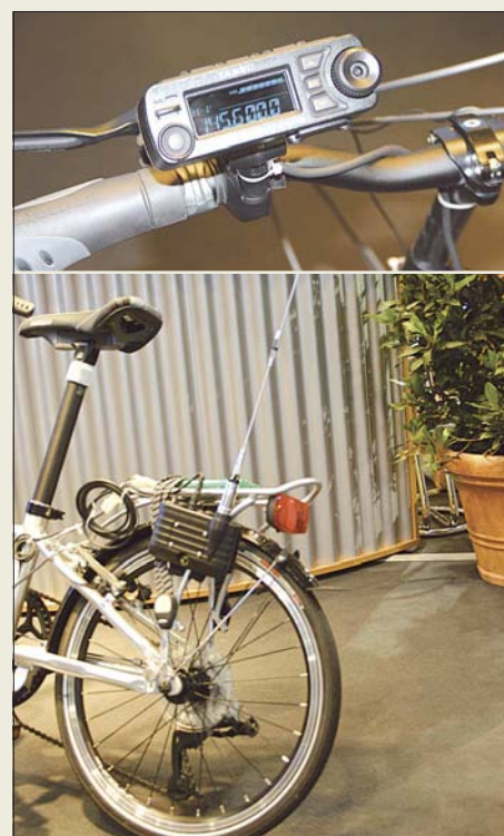
Amateurfunk soll wirklich Spaß machen: Das VHF-/UHF-Mobilfunkgerät FTM-10E von Yaesu bietet mit der optionalen Bluetooth-Funktion völlig neue Möglichkeiten wie z. B. die Montage an einem Zweirad.
