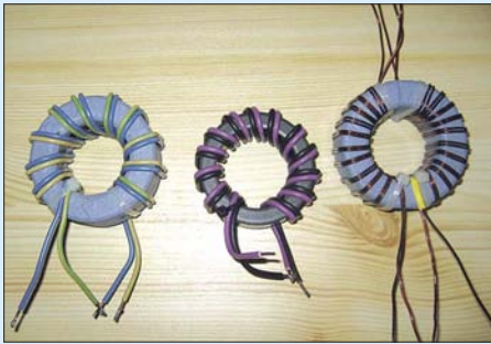
Bild 5: Bewickelte Ringkerne, hier zur Anwendung als Breitbandübertrager (Baluns)
