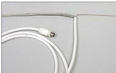
Bild 2: Behelfs-Dipol aus Koaxialkabel
