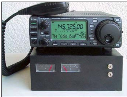
Bild 1: Ein wie füreinander geschaffenes Gesamt: der IC-706 und das 25-A-Netzteil
