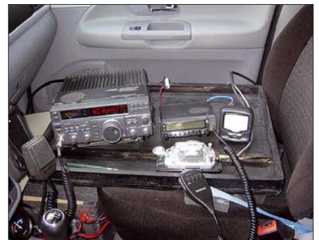
KW- und VHF-Station auf dem Beifahrersitz, außerhalb des direkten Blickfeldes; die Geräte sind auf einer Platte stabil befestigt. Im Fußraum des Beifahrers befindet sich in einem Holzkasten die zweite gepufferte Batterie. Fotos: DL9OBL
