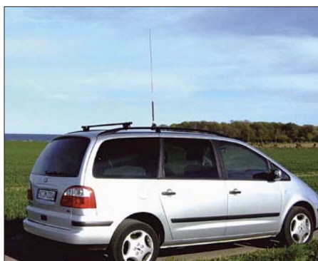
Monobandstrahler für 20 m am Fahrzeug; der hintere Dachträger dient zur Aufnahme von längeren Antennen für den Funkbetrieb im Stand.
