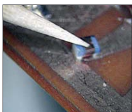
Bild 2: Das Messobjekt lässt sich mit einem Zahnstocher auf die Kontaktflächen drücken.
